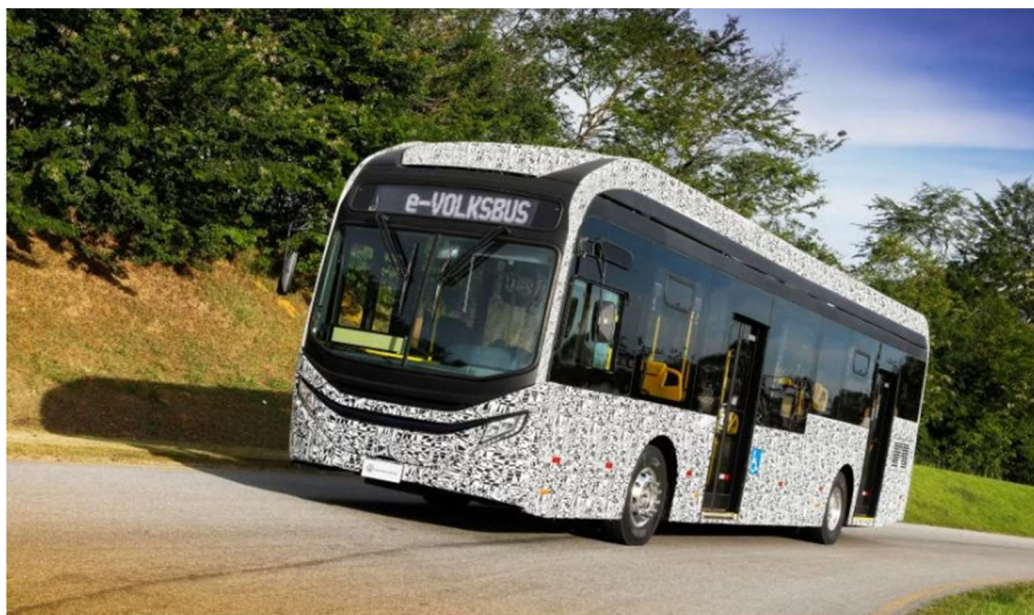
Figura 8: Protótipo de ônibus elétrico da Volkswagen
