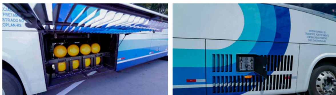
Figura 7: Acondicionamento do GNV no ônibus
