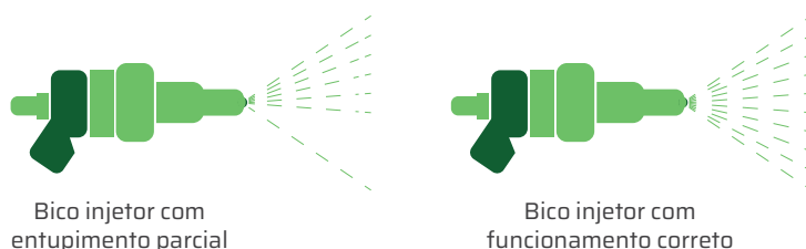
Figura 7: Comparativo entre bico injetor com entupimento (esquerda) e com funcionamento normal (direita)
