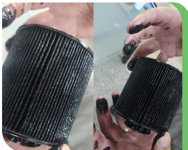
Foto 12: Borra encontrada em filtros de combustível de veículos movidos a diesel
