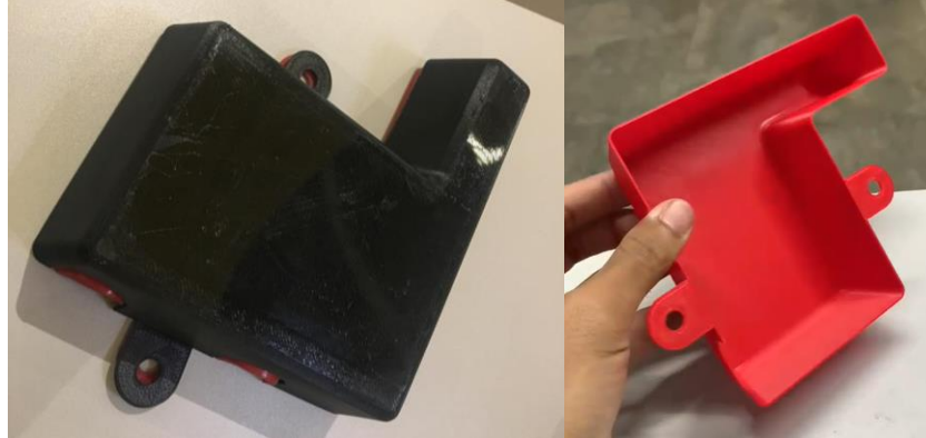
Figura 26 – Peças do lacre de emergência impressas por impressão aditiva
