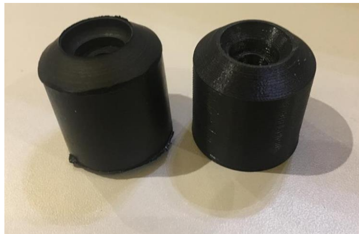
Figura 27 – Peça do batente de porta impressa por impressão aditiva
