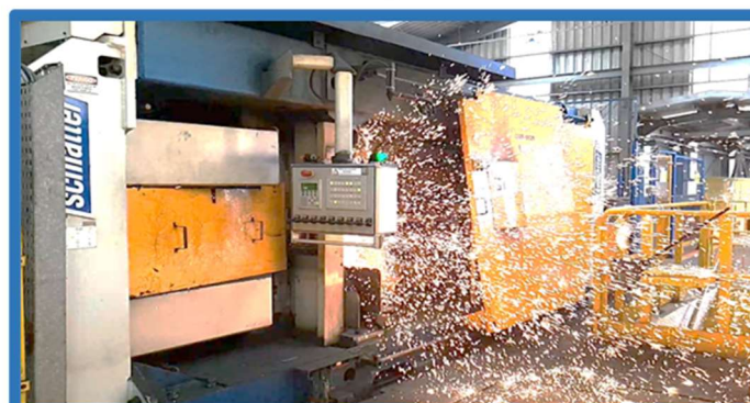
Soldagem, beneficiamento de trilhos curtos
