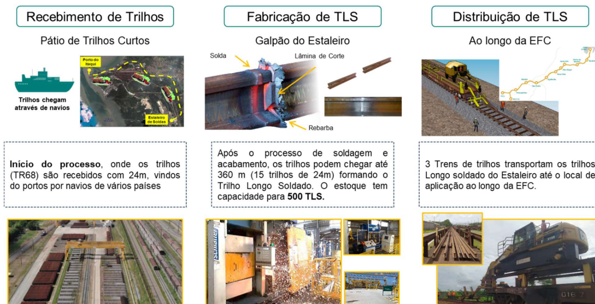
Figura 26 - Processos operacionais do Estaleiro de Soldas
