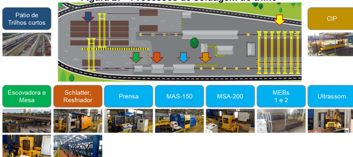
Figura 27 - Processos de soldagem do trilho
