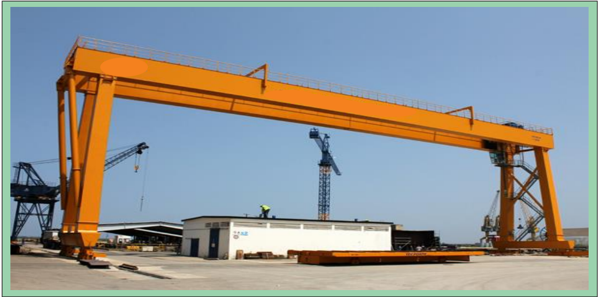
Figura 8 - Pórtico Full Gantry
