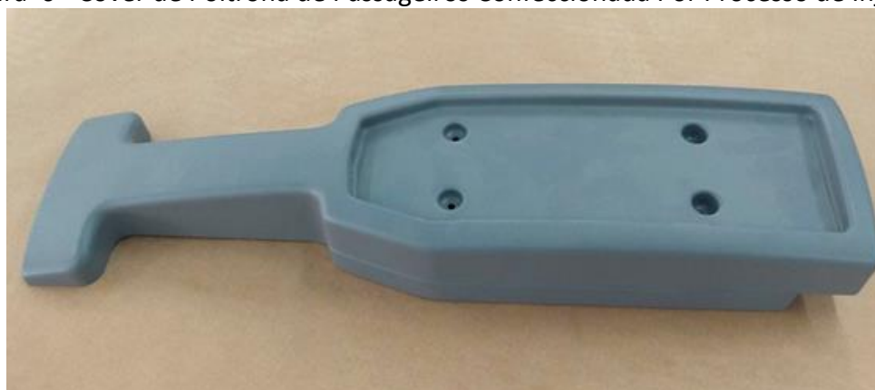
Figura 6 - Cover de Poltrona de Passageiros Confeccionada Por Processo de Injeção
