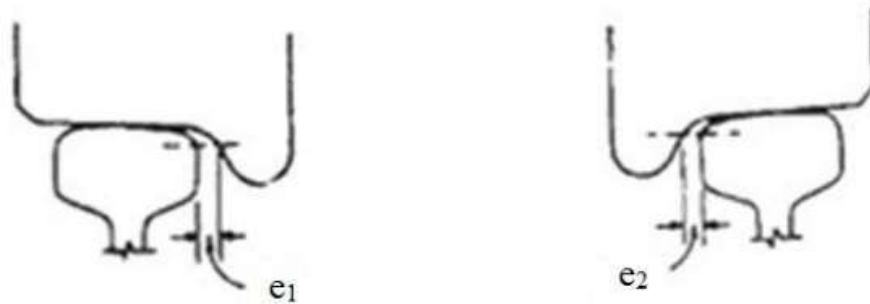
Figura 31 – Afastamento entre flange e trilho
