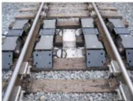
Figura 48 – Medidores de perfil de rodas wayside EFC
