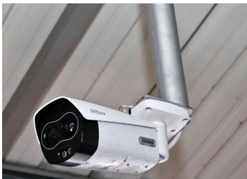
Figura 29 - Câmera de identificação do estado febril dos passageiros do metrô nas estações da Lapa e Pirajá
