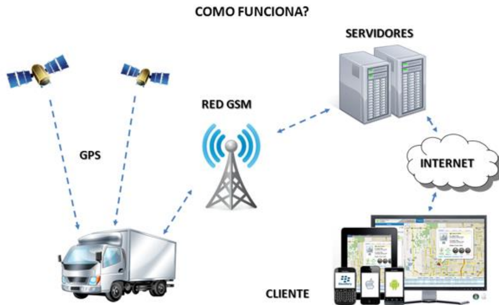
Figura 12 – Como funciona o sistema
