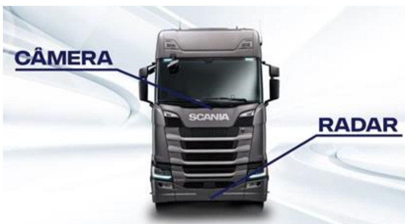
IMAGEM 2 – Equipamentos aplicados com a tecnologia ADAS
