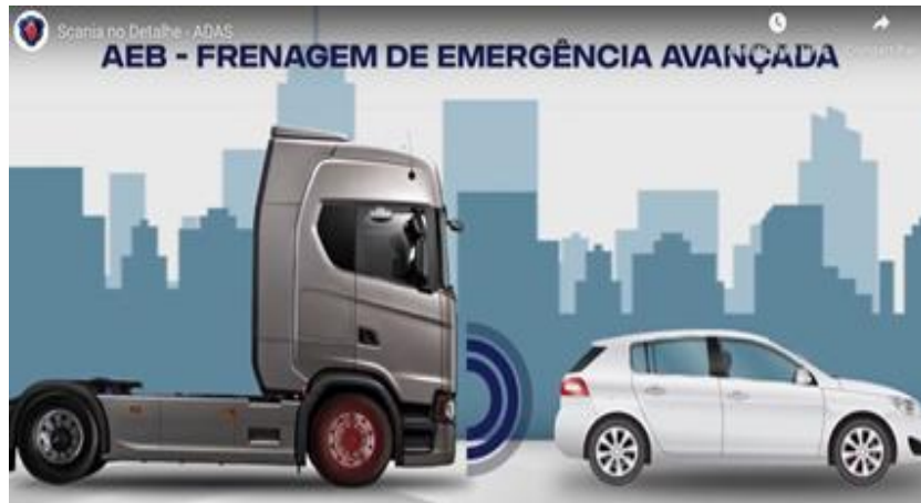
IMAGEM 3 – Acionamento automático do freio na tecnologia ADAS
