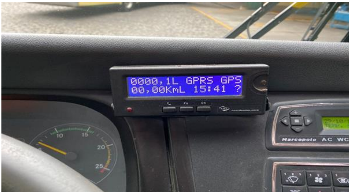
Figura 22. Detalhe do dispositivo de comunicação com o motorista
