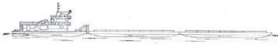
Figura 13 – Desenho Técnico d de Comboio de Empurra.
