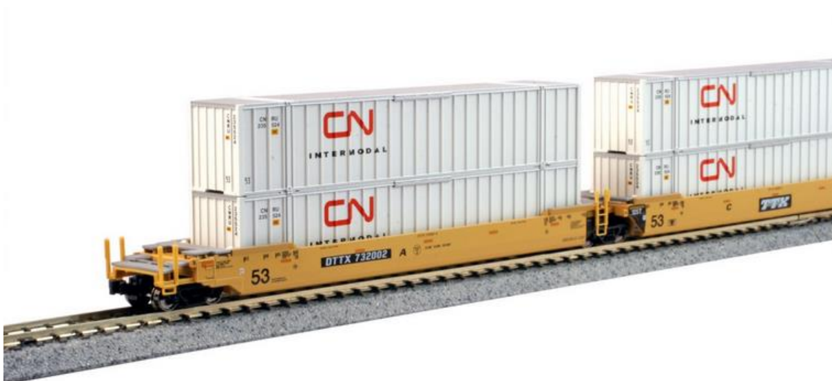
Figura 35 - Modelo de vagão Double Stack para containers de 53" utilizado nos EUA Fonte: (Lombardi hobbies, s.d.)
