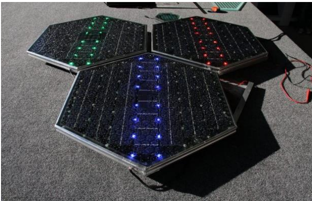
Figura 7: Protótipo das placas para pavimentação com LED
