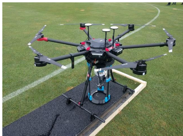
Figura 11: Impressora 3D de asfalto em drone
