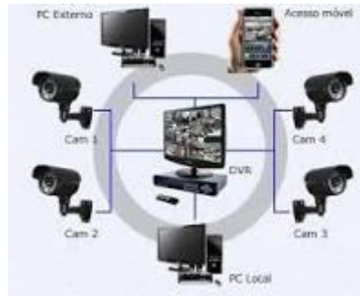
Figura 25 – Arquitetura típica de um CFTV
